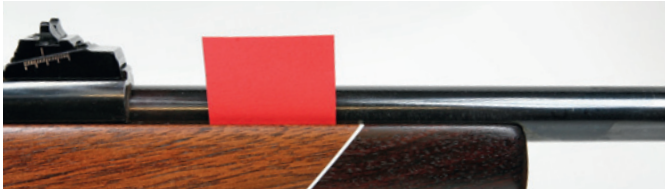
Der Lauf einer Repetierbüchse sollte frei schwingen können. Eine Postkarte muss sich bis zum Patronenlager frei durchziehen lassen.
